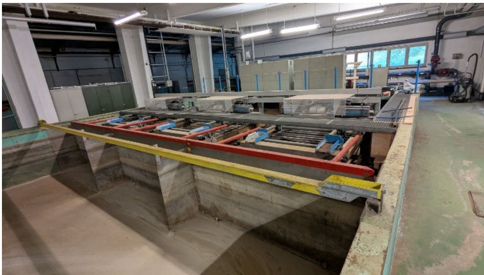
Abb.1: Ort der vorgesehenen Installation des zu beschaffenden Wellenerzeugers für die Flachwasserrinne
